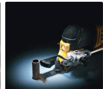
Corte de Tubos ▲
